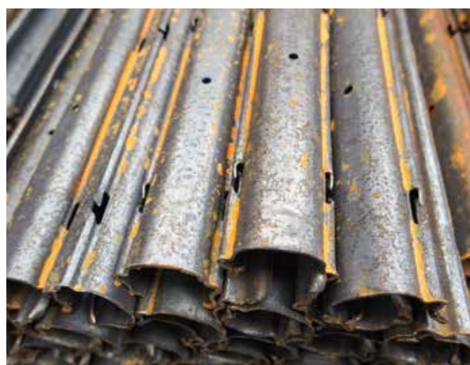
Pali 52x35 con asole interne - Inizio del processo di ossidazione
